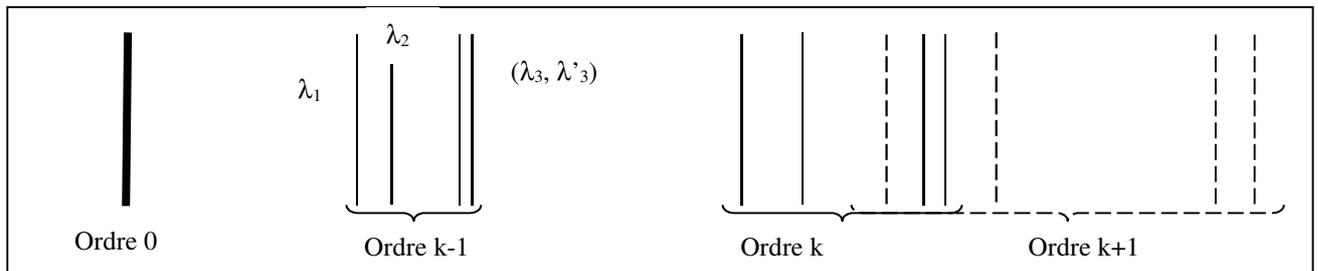
On appelle  $\Delta(\frac{1}{\lambda})$  l'intervalle spectral libre (ISL). Il est directement proportionnel au nombre de traits par unité de longueur - (inversement proportionnel au pas -a- du réseau), et dépend de l'inverse de l'angle sous lequel est effectué l'observation, donc de l'inverse de l'ordre d'interférence k. Pour un réseau de pas donné, plus l'ordre k est élevé plus l'ISL est réduit.
