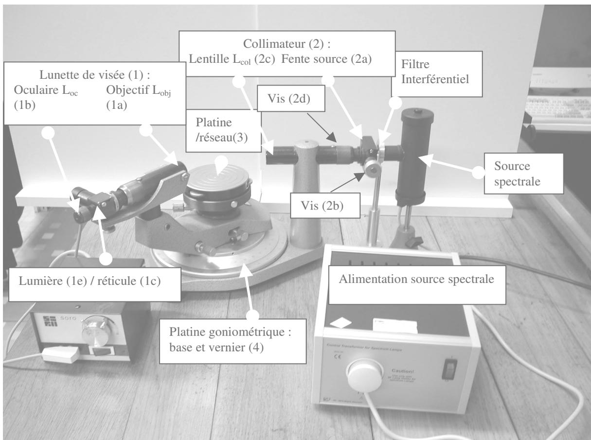
Matériel : une lampe spectrale à vapeur de mercure, un filtre interférentiel pour la raie verte du mercure, un réseaux « Leybold » sur verre, une platine goniométrique.
