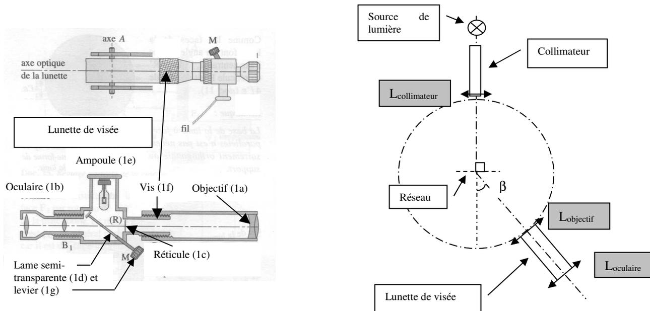
C'est un système centré constitué de deux lentilles, l'objectif  $L_{ob}$  (1a) et l'oculaire  $L_{oc}$  (1b) et d'un réticule (1c). Deux accessoires permettent de faciliter le réglage : la lame semi-transparente (1d) et une ampoule (1e) qui permet d'éclairer le réticule. On peut régler la position relative des deux lentilles avec la vis (1f) et déplacer la lame avec le levier (1g). On peut faire tourner la lunette autour du centre C de façon à explorer un large secteur angulaire  $[\beta]$ .
