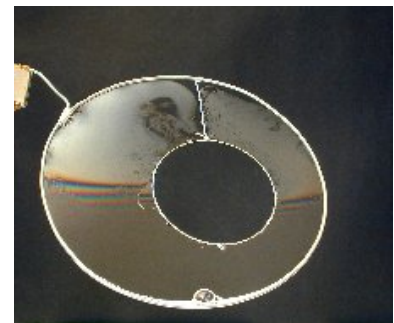
FIG. 2.4 : Mise en évidence des forces capillaires.
