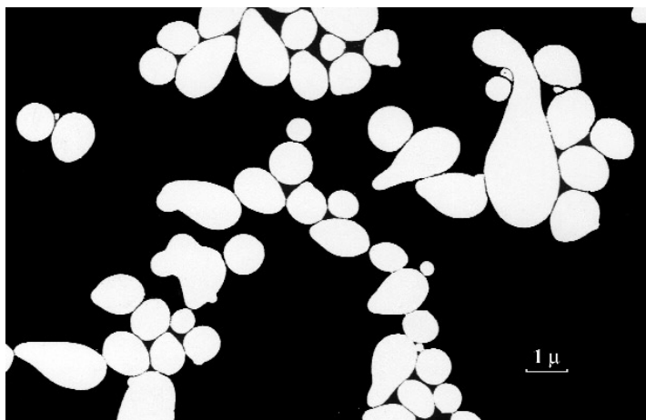
Figure 11 : Vue microscopique du latex qui est une suspension aqueuse contenant des globules, de couleur blanche, de caoutchouc à raison de 37 % en poids [20].
