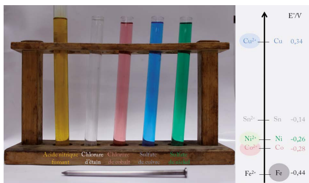
Figure 4 - Image des solutions utilisées pour les expériences et couples d'oxydoréduction des espèces mises en jeu.
