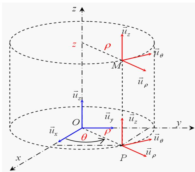
Un point M de l'espace peut être positionné fictivement sur un cylindre d'axe Oz et de rayon  $\rho = PO$  où P est le projeté orthogonal de M sur le plan Oxy. L'axe Oz est appelé axe polaire.
